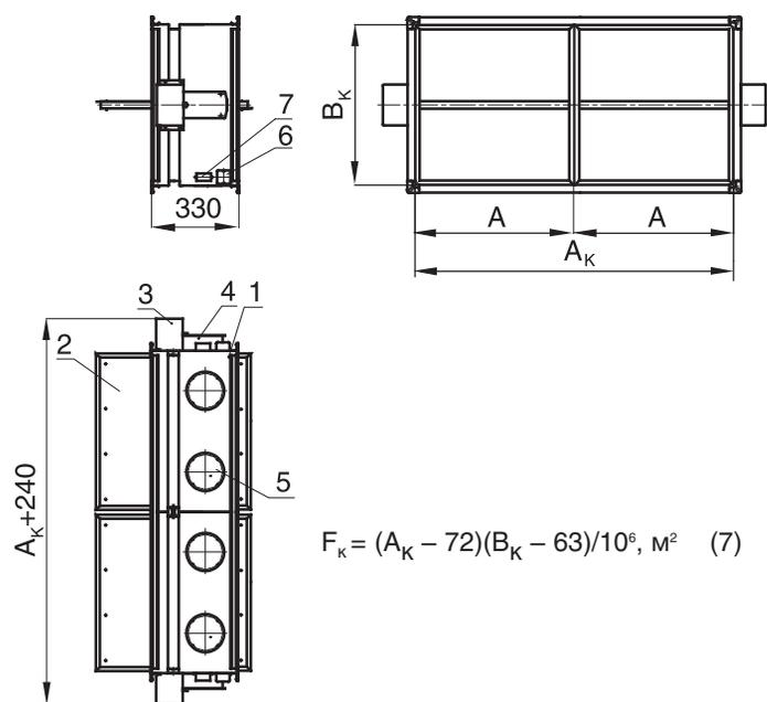
$A_k, B_k$  – размеры внутреннего сечения кассеты (воздуховода), мм
