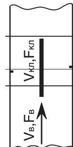
Значения коэффициентов  $\zeta_v$  отнесены к скорости во внутреннем сечении клапана (воздуховода)  $F_v = A \times V$ , м<sup>2</sup>.
