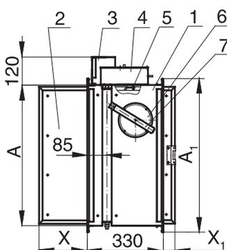
**С пружинным приводом и ТЗ**
